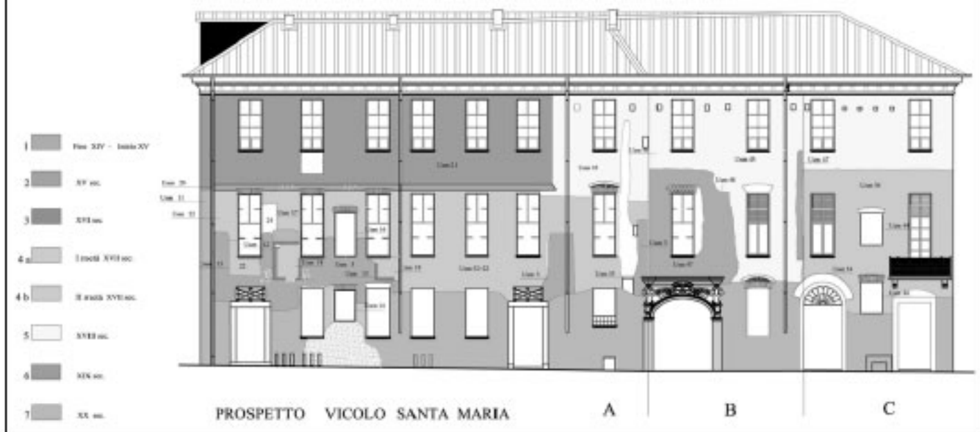
Fig. 180. Torino, via Barbaroux 27. Analisi architettonica e della stratigrafia degli elevati di Palazzo Siccardi sul prospetto di Vicolo S. Maria (ril. E. Genta).
